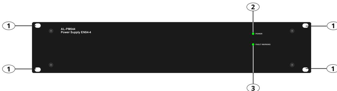
1. N. 4 fori da utilizzare per assicurare il dispositivo al telaio del rackLed accensione
