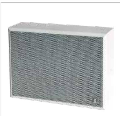
Diffusore sonoro a parete con altoparlante 165 mm full-range. Trasformatore con potenza 6-3-1,5 W 100 V, risposta in frequenza  $175 \div 23.500$  Hz, SPL 1W/1m 100,6 dB. Angolo di dispersione 180°. Struttura in MDF. Dimensioni L x H x P 252 x 192 x 82 mm, peso 1,99 Kg, temperatura di funzionamento  $-20 \div 150$  °C, colore bianco. Completo di morsetto ceramico con termofusibile. Aggancio al pannello montato a muro con viti. Certificato EN54-24.
