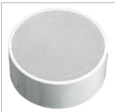
Diffusore a soffitto o a parete con altoparlante 200 mm full-range. Trasformatore con potenza 10-6-3-1,5 W 100 V, risposta in frequenza  $200 \div 24.000$  Hz SPL 1W/1m 101,6 dB. Angolo di dispersione 180°. Struttura in metallo. Dimensioni  $\varnothing$  210 x 90 mm, completo di staffa di fissaggio, peso 2,35 Kg, temperatura di funzionamento  $-20 \div +150$  °C, colore bianco (RAL9010). Completo di morsetto ceramico con termofusibile. Certificato EN54.24.
