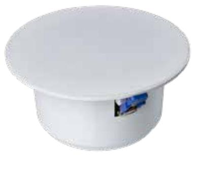
Diffusore a controsoffitto senza cornice a basso profilo, altoparlante 200 mm full-range. Trasformatore con potenza 20-10-5 W 100 V, risposta in frequenza 50 ÷ 18.900 Hz, SPL 1W/1m 105,6 dB. Angolo di dispersione 180°. Dimensioni esterne Ø 265 mm profondità 115 mm, foro fissaggio Ø 240 ÷ 248 mm, peso 1,6 Kg, temperatura di funzionamento -10 ÷ +55 °C, colore bianco (RAL9016). Completo di calotta antifiama e morsetto ceramico con termofusibile. Connettore Wago 221. Certificato EN54-24.
