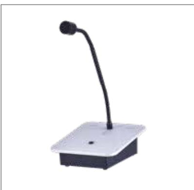
Base microfonica completa di gooseneck con microfono dinamico. Completamente monitorata come richiede la norma EN54-16. Tasto "talk", led "busy" e "system". La funzione del tasto è completamente programmabile da software. Alimentazione tramite cavo RJ45 proveniente dalla centrale o tramite alimentatore locale ALCM24V (optional). Certificata a norme EN54-16 - n. 0068-CPR-018/2016.
