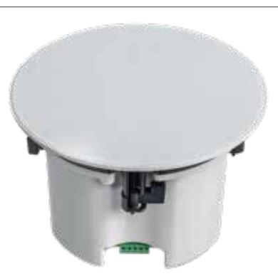
Diffusore a controsoffitto senza cornice a basso profilo con altoparlante 130 mm coassiale 2 vie. Trasformatore con potenza 25-12,5-6,25 W 100 V, risposta in frequenza 111 ÷ 21.600 Hz, SPL 1W/1m 92,1 dB. Angolo di dispersione 180°. Dimensioni esterne Ø 216 mm profondità 141 mm, foro fissaggio Ø 187 mm, peso 2,4 Kg, temperatura di funzionamento -10 ÷ +55 °C, colore bianco (RAL9016). Completo di calotta antifiama e morsetto ceramico con termofusibile. Connettore Wago 221. Certificato EN54-24.
