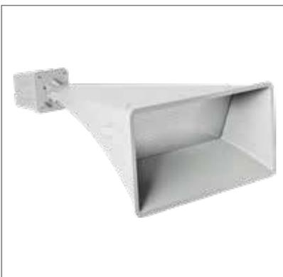
Diffusore a tromba studiata per la sonorizzazione di grandi spazi. Trasformatore con potenza 100-50-25 W 100 V, risposta in frequenza 250 ÷ 10.000 Hz SPL 1W/1m 119 dB. Angolo di dispersione orizzontale 58° x verticale 28°. Dimensioni 1.228 x 468 x 832 mm, peso 18,6 Kg, temperatura di funzionamento -20 ÷ +90 °C, colore (RAL7023). Grado di protezione IP 33. Completo di morsetto ceramico con termofusibile. Certificato EN54-24.
