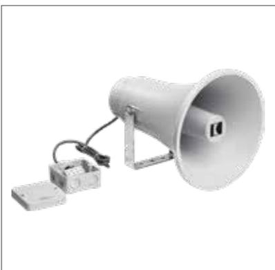
Diffusore a tromba in ABS. Trasformatore con potenza 30-20-10-5 W 100 V, risposta in frequenza 250 ÷ 15.000 Hz SPL 1W/1m 110,1 dB. Angolo di dispersione 360°. Passacavo waterproof, dimensioni Ø 235 x 303 mm, peso 2,17 Kg, temperatura di funzionamento -20 ÷ +150 °C, colore grigio (RAL7035). Grado di protezione IP 66. Completo di morsetto ceramico con termofusibile. Certificato EN54-24.
