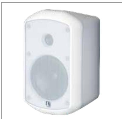
Diffusore monitor a parete, sistema 2 vie con woofer 100 mm e tweeter da 1". Trasformatore con potenza 50-25-12,5-6,25 W 100 V, risposta in frequenza 53 ÷ 20.300 Hz, SPL 1W/1m 88,2 dB. Angolo di dispersione 360°. Struttura in ABS. Dimensioni L x H x P 326 x 202 x 192 mm completo di supporto basculante, peso 3,58 Kg, temperatura di funzionamento -25 ÷ +70 °C, colore bianco. Completo di morsetto ceramico con termofusibile. Certificato EN54-24.
